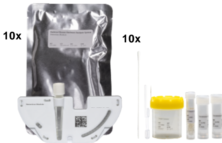
Abbildung 1: Detektionsmodul (links) und Konzentrationsmodul (rechts) des Food & Beverage Kit, Type Spoilage Bacteria Ident v2.
